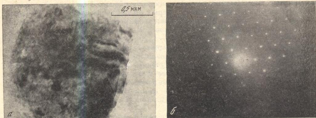
Рис. 6. Электронно-микроскопический снимок частицы  $\text{SiO}_2$  (реплика с извлечением) (а) и микродифракция с частицы  $\text{SiO}_2$  (б)
